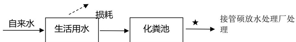
图 3-1 本项目废水处置流程及监测点位示意图（★为废水监测点位）
